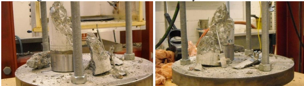
Figur 20: Provkropp överbelastad vid pålastning av en belastningsnivå lika med 80%.
